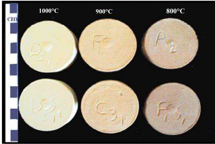
لوحة 2-3 التدرج اللوني واستقامة الحافات لبعض عينات طابوق البناء الاعتيادي بدرجات الحرارة المختلفة
