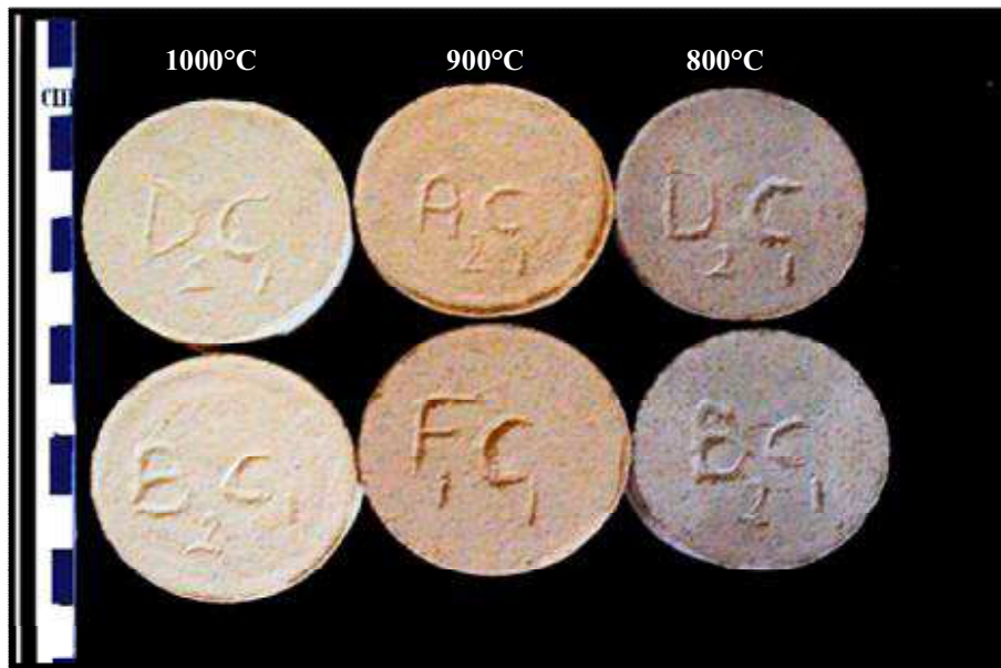
لوحة 2-3 التدرج اللوني واستقامة الحافات لبعض عينات طابوق البناء الاعتيادي بدرجات الحرارة المختلفة
